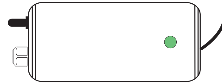
Un DEL vert indique que la lampe UV est « ON ».
