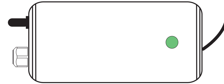
El LED verde indica que la lámpara de UV está "Encendida".
