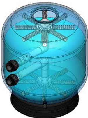
3- Quando il serbatoio sarà pieno di OC-1, avvitare i laterali e rimettere il diffusore in posizione verticale. (Assicurarsi che la linea aperta sia posizionata in cima al filtro).
