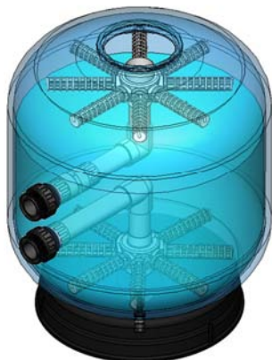
3. Wenn der Filter mit dem OC-1 Filtermaterial gefüllt ist, die Seitenteile wieder auf die Nabe schrauben und den Diffuser in eine vertikale Position drehen. (Sicherstellen, dass die offene Leitung zur Filteroberseite zeigt).
